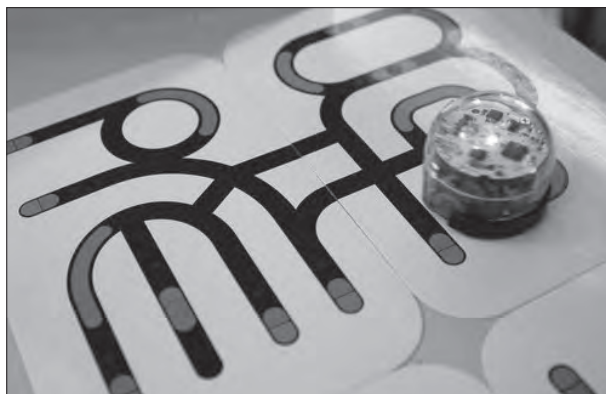
図2 線の色を認識するロボットOzobot (文献19より)
